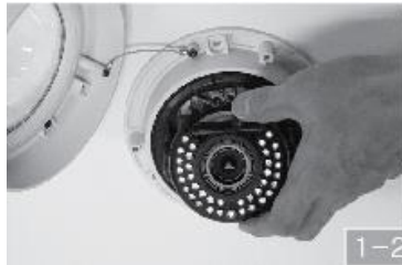
Отрегулируйте приближение/удаление («зум») и фокус. (Не фиксируйте винтовые регуляторы, просто переместите их в требуемое положение)
