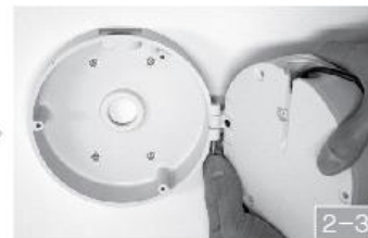
Подсоедините камеру к основанию при помощи шарнира (Ваши руки станут свободными)
