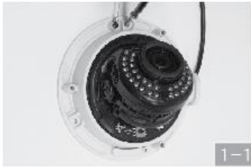
После подсоединения кабелей закрепите купол болтами
