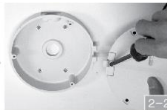
Закрепите шарнирную часть к камере болтом
